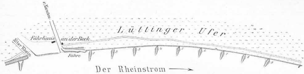
Abb. 22. Uferdeckung mit Kopfschwellen (Nobiling's) am Lüttinger Ufer bei Xanten.
