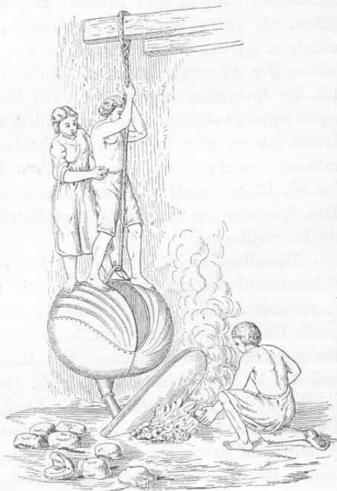
Fig. 22. Eisengewinnung in den Khasiabergen. Nach HOOKER.
