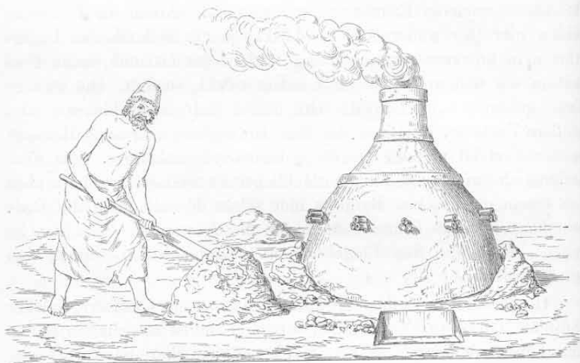
Fig. 12. Schmelzofen in Futa Djallon. Nach LAMBERT.
