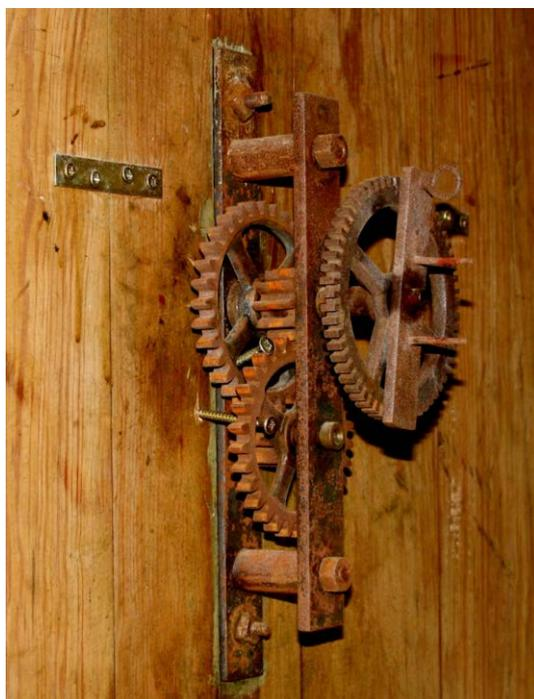
Schloss Burg, Batterieturm. Zeigergetriebe der Turmuhr auf der Rückseite des Zifferblatts.
