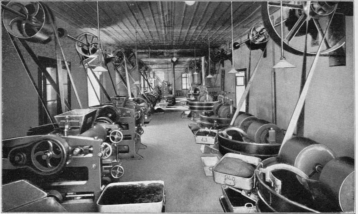
Abb. 2. Melangeure (Mischmaschinen) und Wälzwerke
