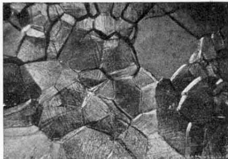
Fig. 75. Ag , geschmolzen, körnige Oberfläche. Vergrößerung 16.
