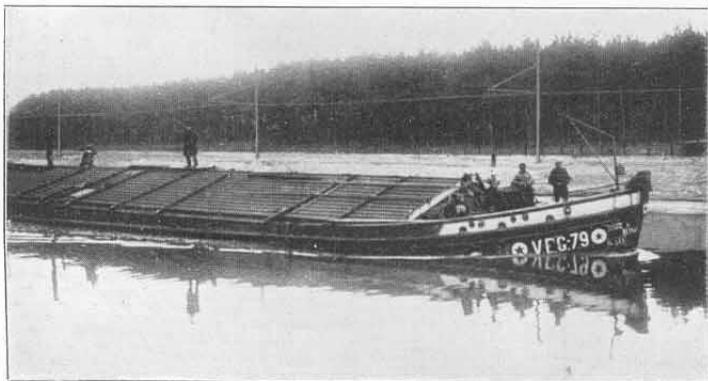
Fig. 31. Bugwelle eines vom Ufer aus geschleppten Lastschiffes.
