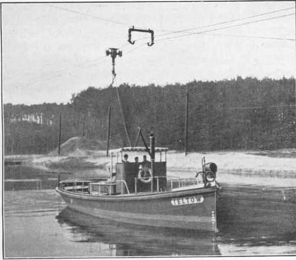
Fig. 12. Elektrisches Schleppboot »Teltow« mit Stromabnehmerwagen Lombard-Gérin, 1903.
