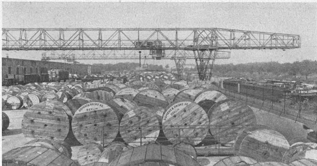
Abb. 7. Verladeplatz für die Kabeltrommeln am Kabelwert der Siemenswerke
