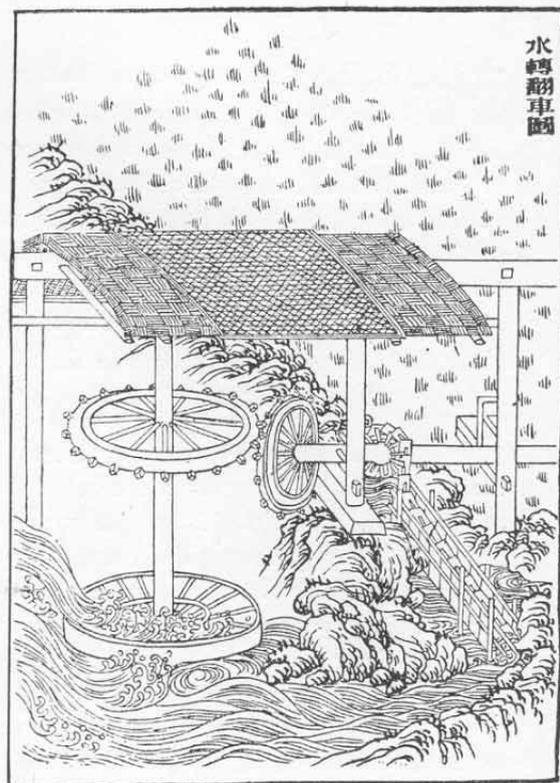
Fig. 14. »Drehkette« für Wasserkraft.
