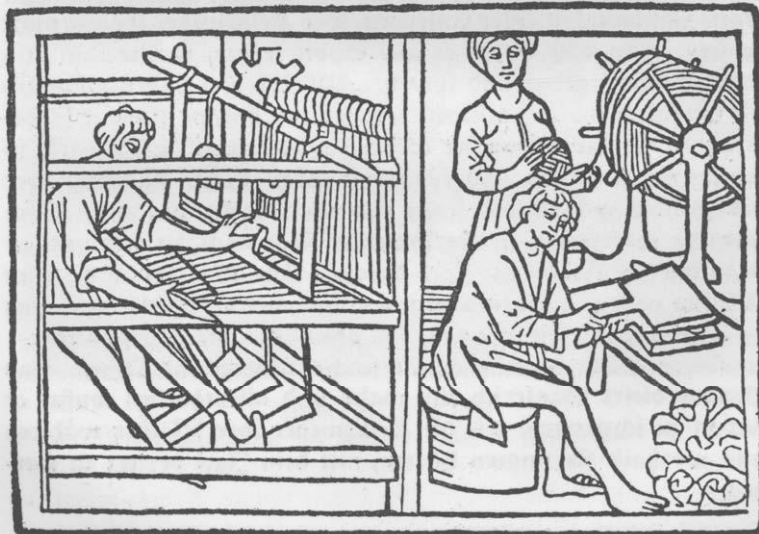
Wollweber am Webstuhl und Zerstellung des Garnes
